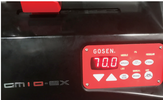
[上]適正テンション(写真)を大きく超える張り方は、ラケットの破損やケガの原因になる [下]60ポンド以上で張ることは可能だが、そのぶんリスクも高まる
